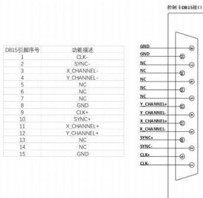
图 6-4 DB15 振镜标准定义
